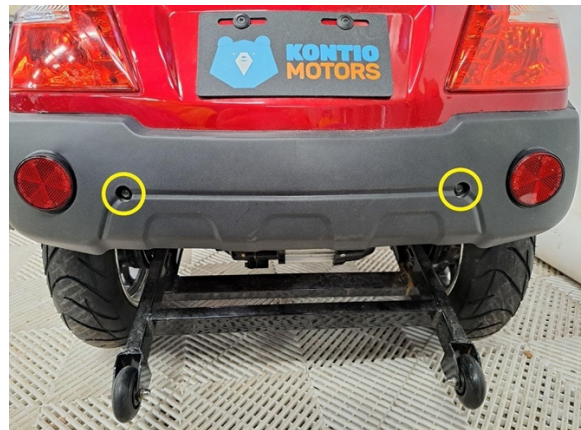
Irrota takakatteen kaksi kiinnityspulttia. (hylsy 8 mm).
